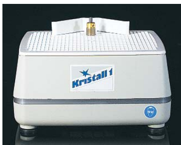
30 102 00 KRISTALL I 280 x 235 mm Arbeitsfläche, 100 W, 2255 U/min, Präzisionskugellager, incl. Thermoschutz, Spritzschutz, 19 mm Schleifkopf
