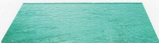
Die gehämmerte Struktur des Tisch-Kathedralglases ist gut zu erkennen. Im unteren Bereich verläuft eine für dieses Tafelglas typische Quetschstelle.
