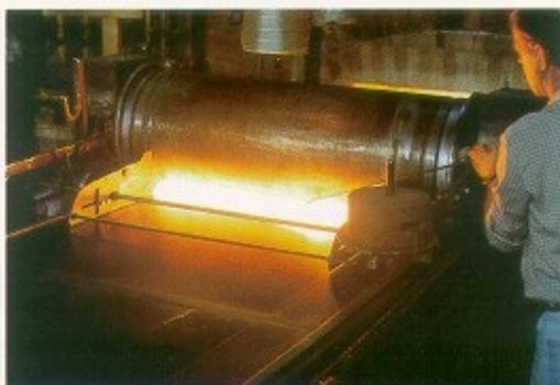
Beim Tisch-Kathedralglas wird die flüssige Glasmasse auf einen Stahltisch aufgegossen und mit einer Walze glattgewalzt. Die Struktur entsteht durch das Temperaturgefälle beim Walzvorgang.
