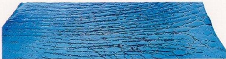
Das mundgeblasene Cracked Glas (Titelseite und oben) unterscheidet sich vom Original-Echt-Antikglas durch den Cracked- oder Craquelé-Effekt. Es ähnelt mit seiner rissig-narbigen Oberfläche in seiner Optik der Struktur einer Krokodilhaut.
