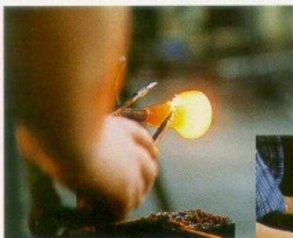
... dieser wird aufgeblasen, geöffnet und zur Butze gedreht.
