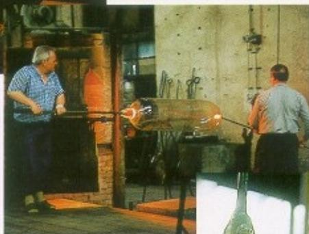
ße dieses Ballons findet der Vorgang in einer Grube statt. Während des Blasens wird der Glasballon ständig in einer Form gedreht, hierdurch entsteht die Oberflächenstruktur, der Hobel. Nach Erreichen der endgültigen Größe wird eine Seite des Ballons geöffnet und ausgeweitet. Nach Abschlagen der Glasmacherpfeife entsteht ein gleichmäßiger Glaszylinder. Dieser wird dann der Länge nach aufgeschnitten, erneut erhitzt, aufgeklappt und zur fertigen Glas-tafel glattgebügelt.
