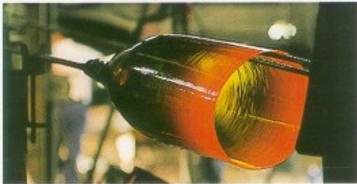
Der glühende Glasballon wird auf beiden Seiten aufgeschnitten und mit der Auftreibschere zu einer Walze geformt.
